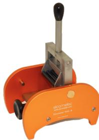
Elcometer 1506-B在使用上类似1510，仪器结构同样坚固，用于测试板型金属上干涂层的弹性，附着力和延展性。
